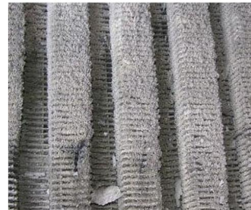
**Селективность** - для защиты своего оборудования производители рекомендуют фильтры с ячейками 100-200 микрон.
